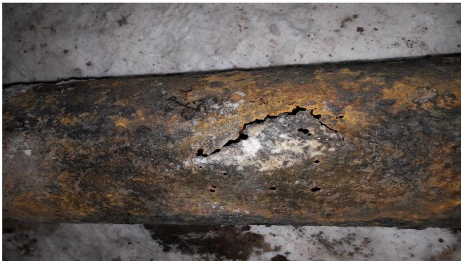
Всего данный участок трубопровода эксплуатировался уже более 11 лет. Работники ГУП ПЭО «Байконурэнерго» г.Байконур всего за сутки смогли заменить его без повреждения асфальтового покрытия и других коммуникаций.
